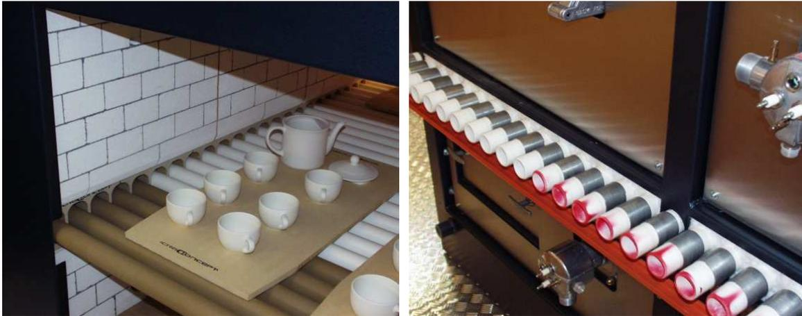
Bild 2: Einbausituation für zylindrische Rollen
