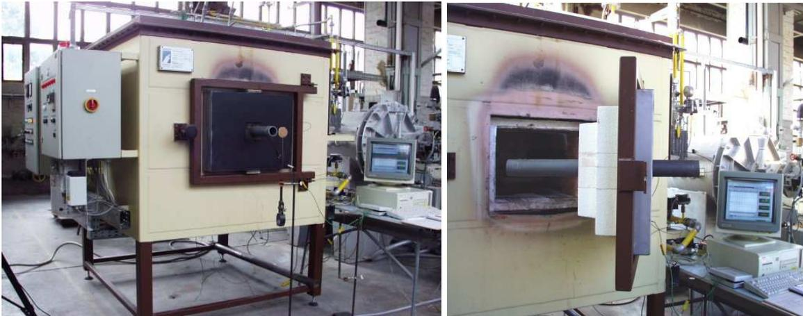
Bild 56: Realisierung einer Rollendurchführung ohne Spalt am Versuchsofen
