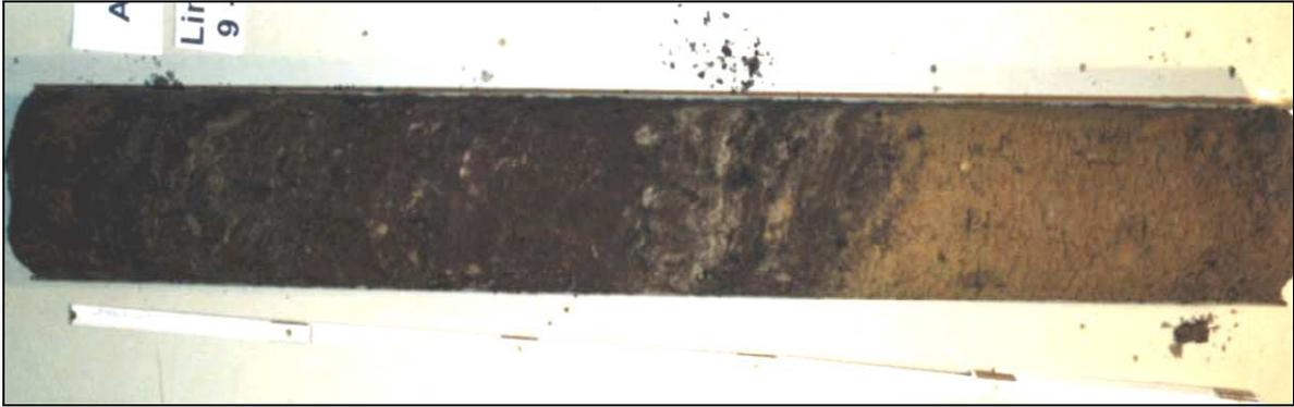
*Bild 8: Vollständiger Bohrkern, aus Tiefe  $t = (9,0 \dots 10,0)$  m, 1,0 m lang*
