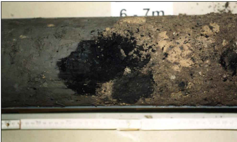
*Bild 11: Kohlestück im Kernrohr zwischen Ton (links) und Schluff (rechts)*
