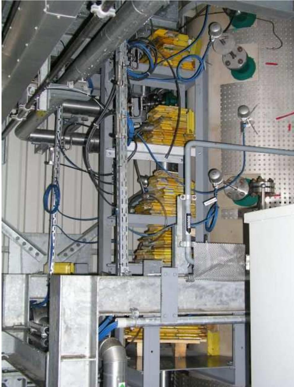
**Abbildung 3.3:** Am Reaktor installierte Detektoren zur Verweilzeitmessung
