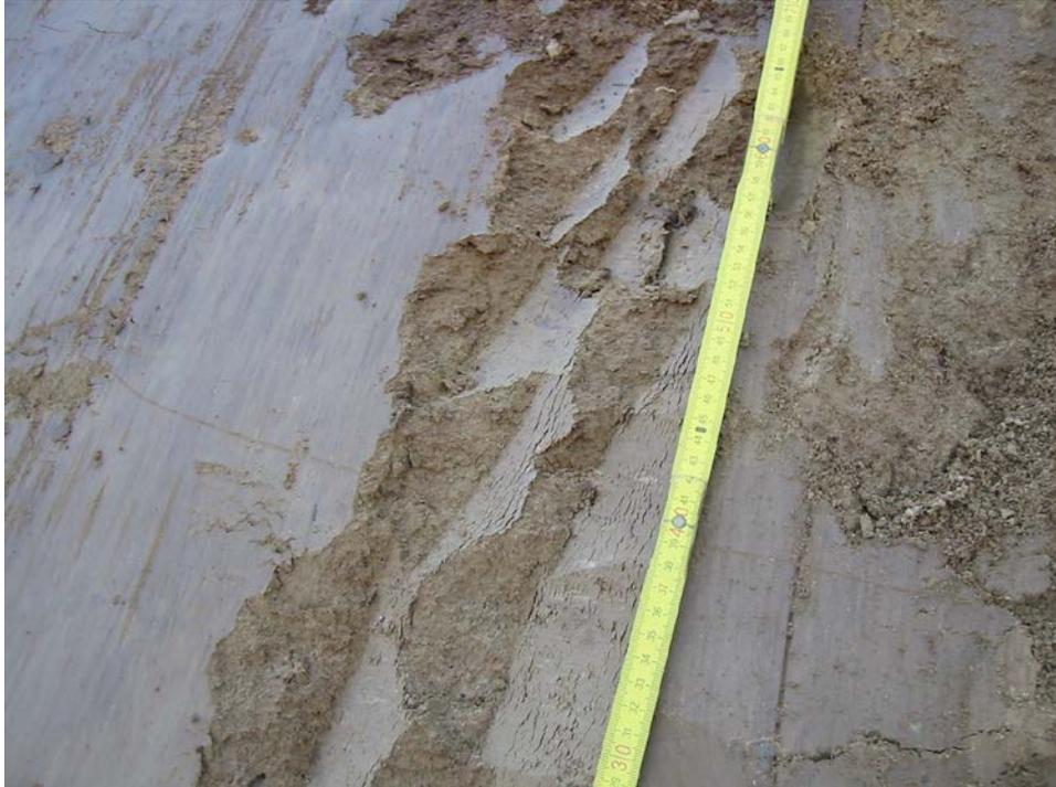
Foto 5: Detailaufnahme der Baugrubenböschung, WL Wiesbaden, Schicht 2, Schluff, feinsandig, steife Konsistenz, ca. 107 bis 109 m NN.
