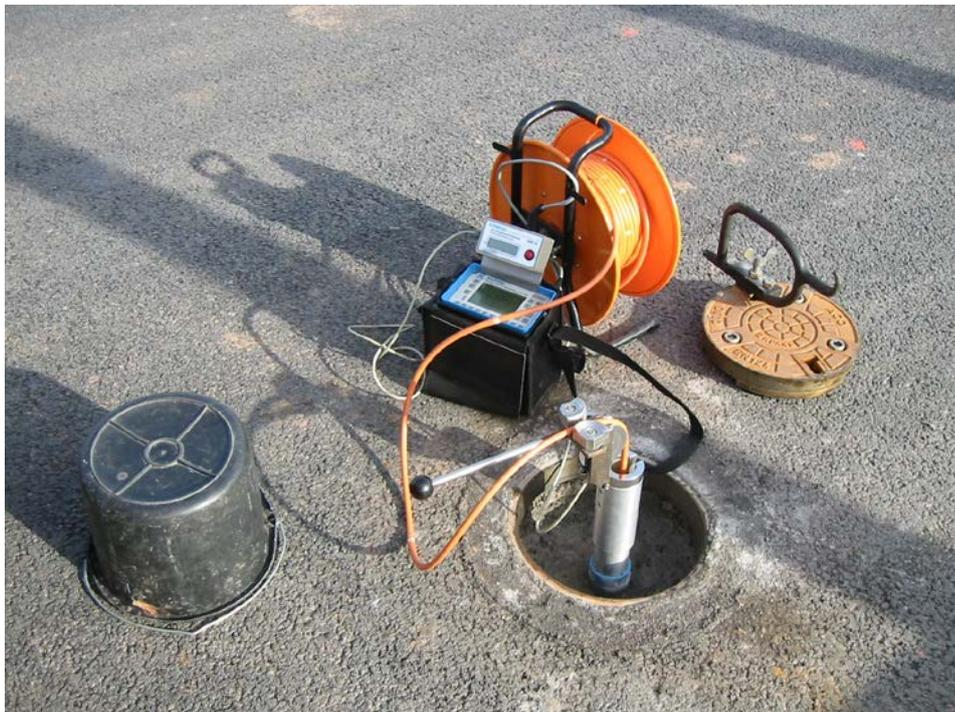
Foto 16: Messung Vertikalmesststelle mit Kappe im Fahrbahnbereich des späteren
