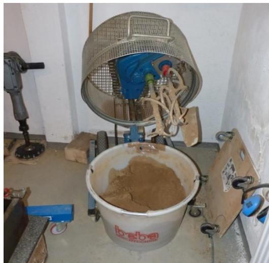
**Bild 5.10** Für die Homogenisierung und fürs Mischen verwendeter Zwangsmischer
