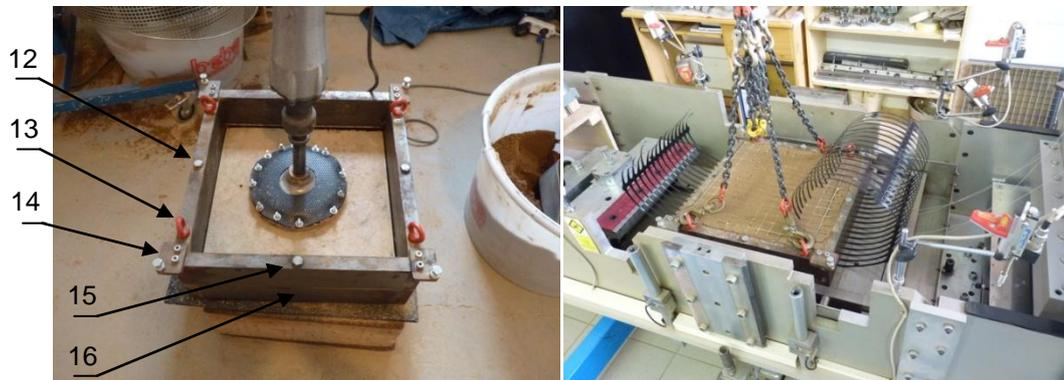
**Bild 2.3** Inlayrahmen zur Entkopplung des Probeneinbaus
