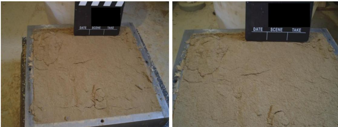
**Bild 5.17** Bilder eines Scherversuchs mit Trennfläche an CS5, bei dem die Trennfläche zu hoch angeordnet wurde
