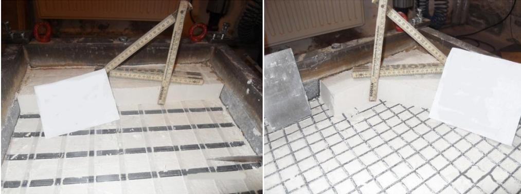
**Bild 4.2** Aufnahmen des Mat. 6 (links) und des Mat. 8 nach dem Reibungsversuch mit Kaolin
