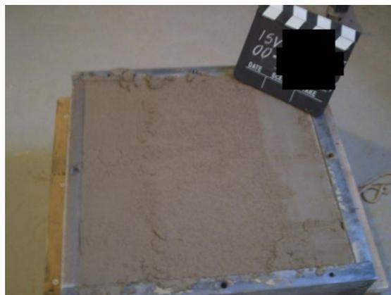
**Bild 5.18** Bilde eines Scherversuchs mit Trennfläche an CS5, bei dem die Trennfläche sich in Höhe der Scherzone befunden hat
