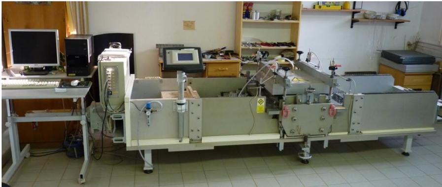
**Bild 2.1** Geokunststoff-Boden-Interaktionsprüfgerät (IPG)
