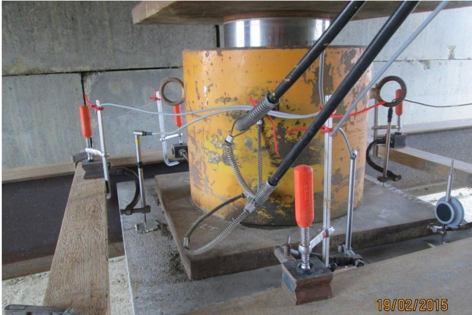
Abb. 6: Pfahlkopfinstrumentierung und Belastungseinrichtung
