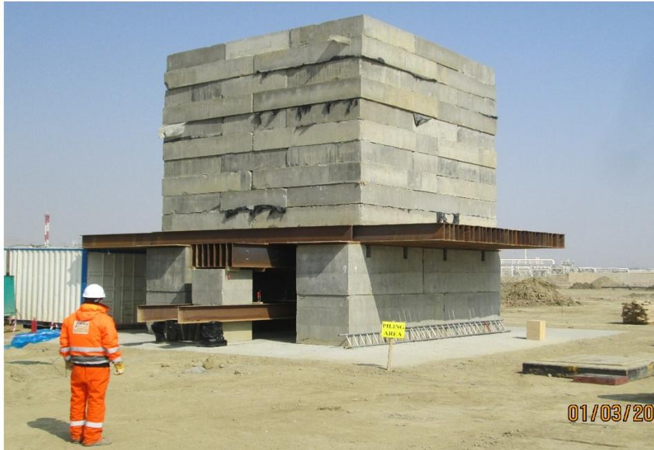
Abb. 7: Ansicht Totlastsystem
