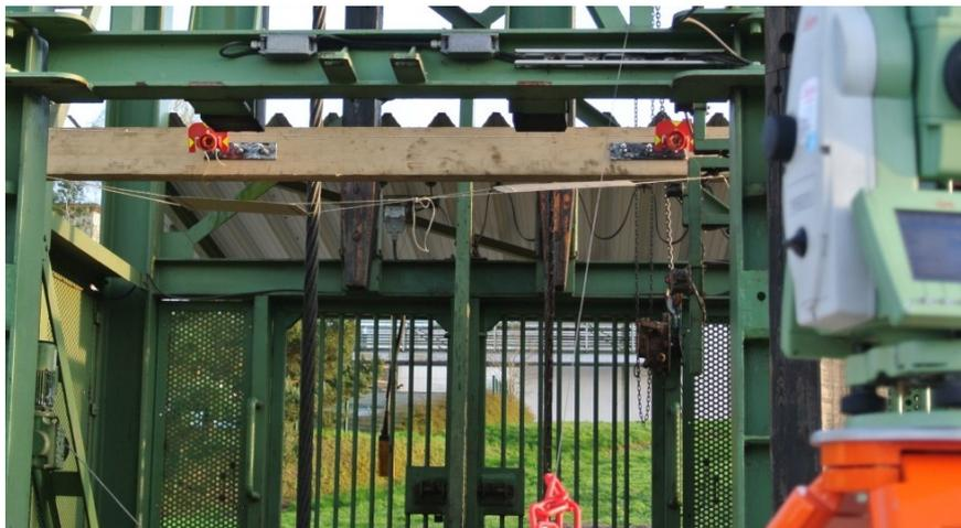
Abb. 15: Eingebauter Balken mit Prismen, Lotdraht und Tachymeter für Lotanschlussmessung
