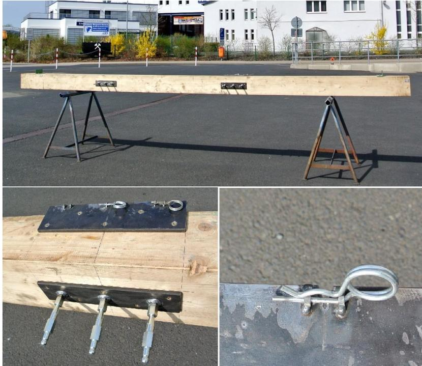
Abb. 14: Präparierter Balken mit Lotkerben und Aufnahmen für Prismen
