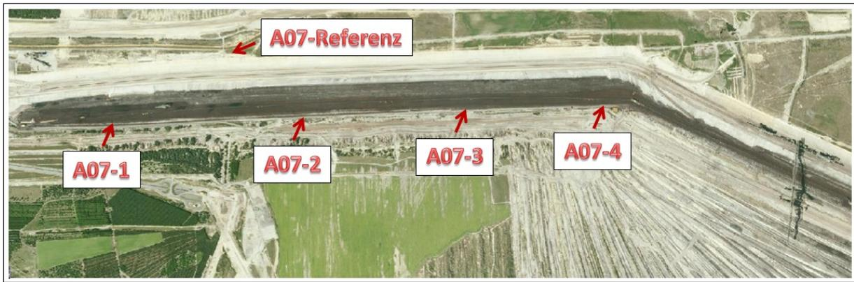
Abb. 4: Position der Empfänger im Randschlauch
