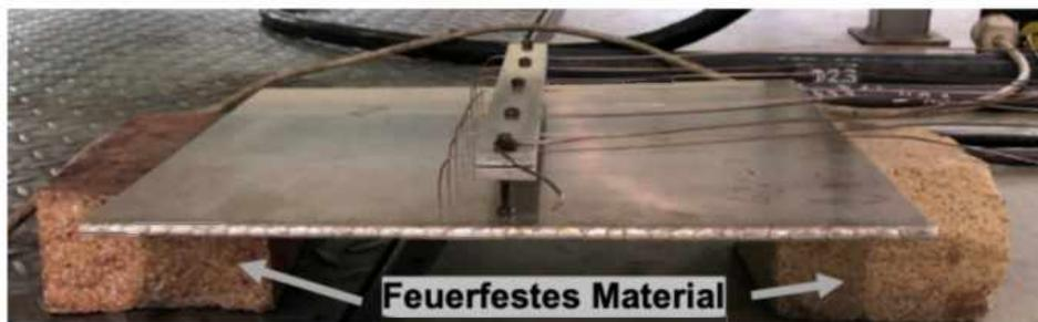
Abbildung 35: Position des Magnesiumbleches beim Abkühlen nach der Erwärmung im Ofen
