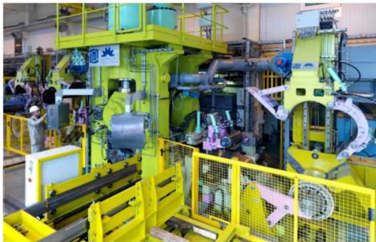
Abbildung 6: Quarto-Reversiergerüst für die Magnesiumbandherstellung [25, 26]
