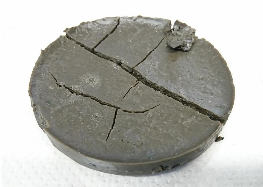
**Abbildung 15: Abfiltrierter titan-, vanadium- und eisenhaltiger Niederschlag nach Anheben des pH-Wertes**
