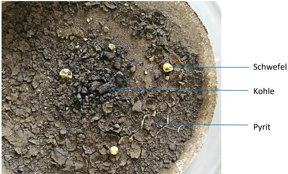
**Abbildung 13: Filtrerrückstand der unlöslichen Bestandteile von Sulfafer**
