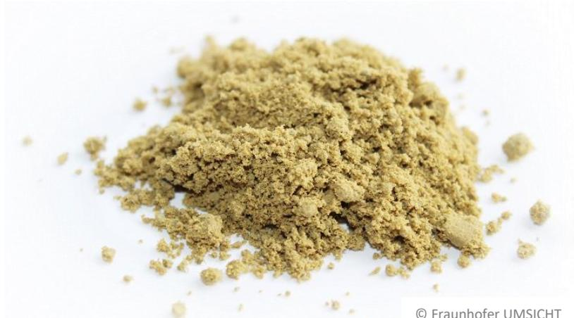
**Abbildung 10: Titan- und vanadiumhaltiges Einsatzmaterial aus der Pigmentindustrie**
