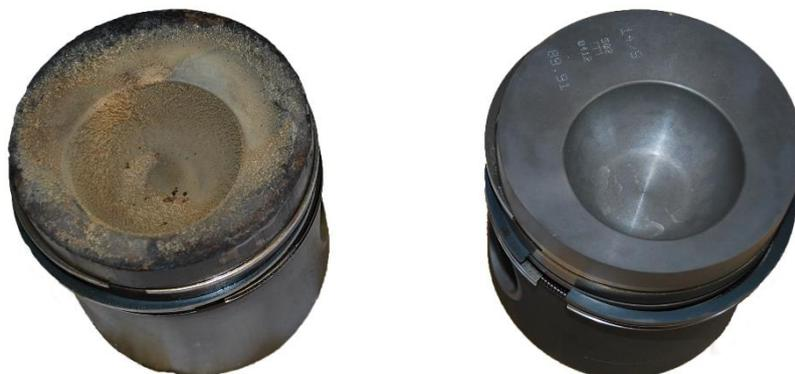
**Abbildung 4.5** – Kolben des Ottomotors mit Ablagerung nach Einsatz (links) und im Neuzustand (rechts)
